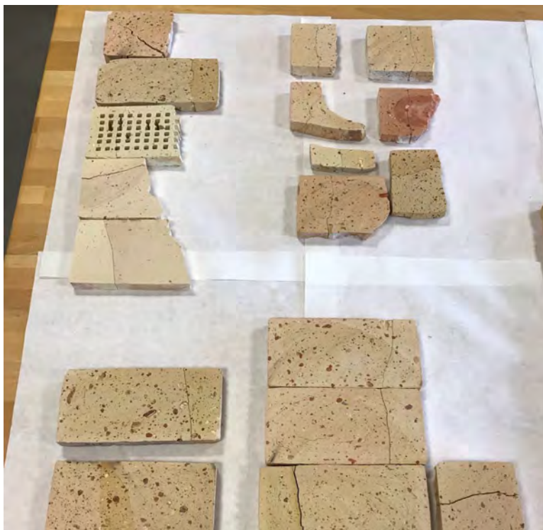
Foto 35. Foto fra genbrændingsforsøg af prøver fra blok 4, Teknologisk Institut
