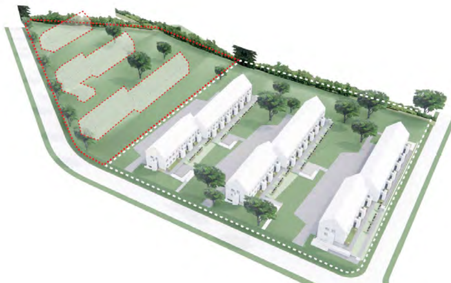
3 eksisterende blokke nedrives, og mursten genanvendes til efterisolering af de tre blivende blokke.
