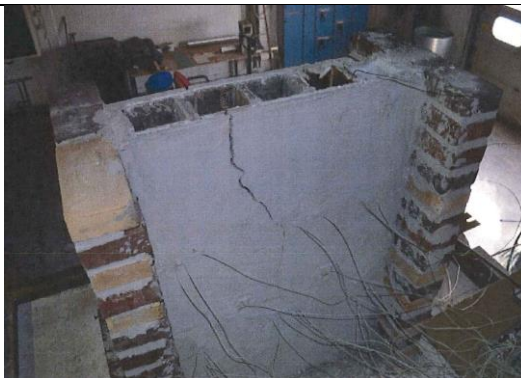
Figur 32: Foto af testopstilling i laboratorie af opmuret aftrækskanal til brandtest.
