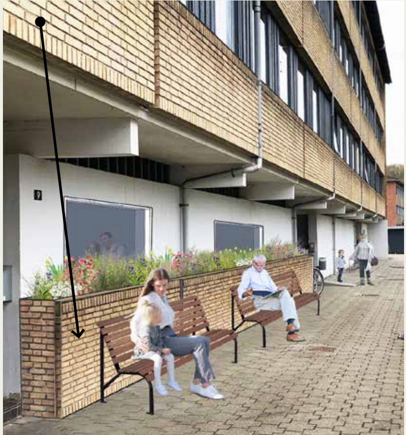
Skitse: genbrug af murstensfelter som integreret plantebed i facade uden på efterisole- ring. Skaber en reference til den gamle facade samt til de eksisterende gavle. Giver varme og stoflighed nede i menneskelige skala/højde
