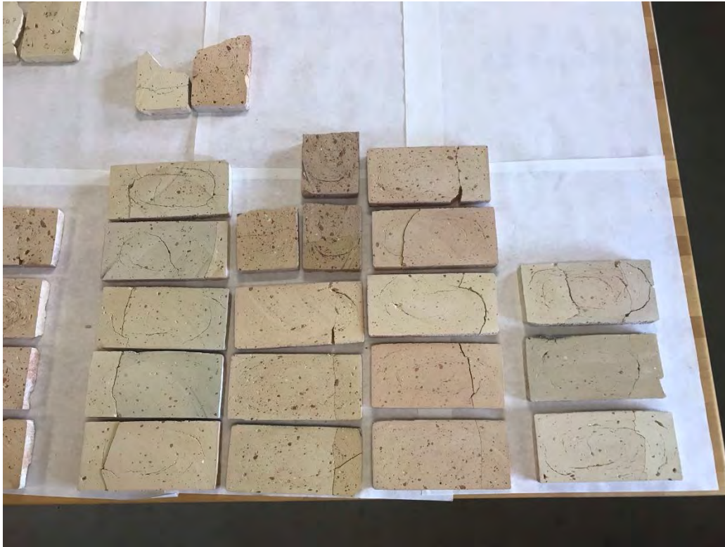
Foto 37. Foto fra genbrændingsforsøg af prøver fra blok 6.
