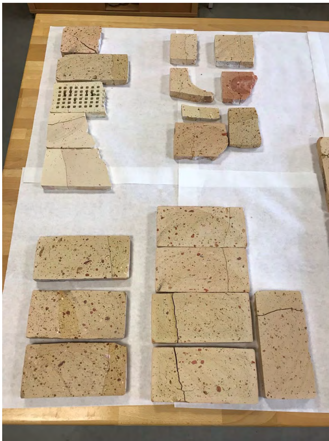
Foto 35. Foto fra genbrændingsforsøg af prøver fra blok 4.
