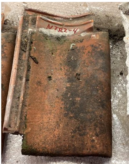
Fig. 5. Tagsten NTR2.4. Bemærk "krater" i venstre halvdel, ca. midt på, med begroning.
